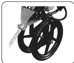
②車輪ステー内側への車輪取付
