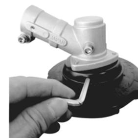
3. ディスクを固定したままディスク裏側のナットを付属のプラグレンチで外します
