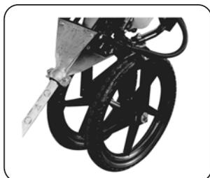
②車輪ステー内側への車輪取付
