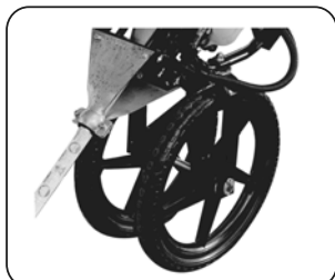
②車輪ステー内側への車輪取付
