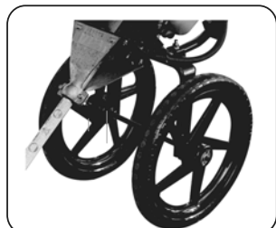
①車輪ステー外側への車輪取付
