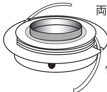
両側とも約20cm引き出した状態にして切込みに仮止めします。
