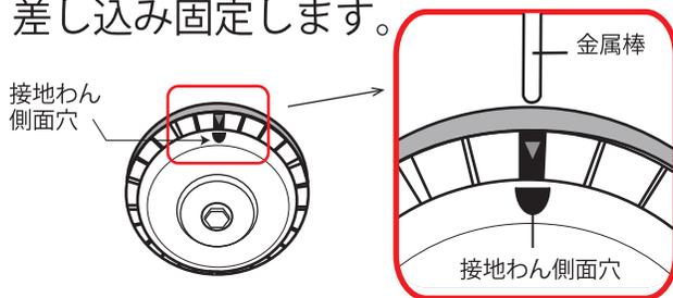
ディスク側面の穴にドライバー等を差し込み、“あける”の方向にディスクを回し、ディスクとせっちか下部を外します。
