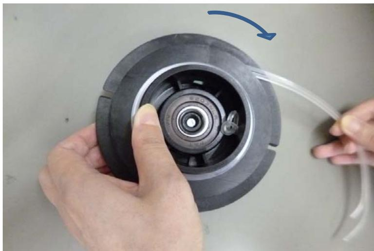
コードを中央で結び、片方のコード差込口から2本一緒に内側から外側に出し、2本そろえて時計回りにしっかり巻付けます。
